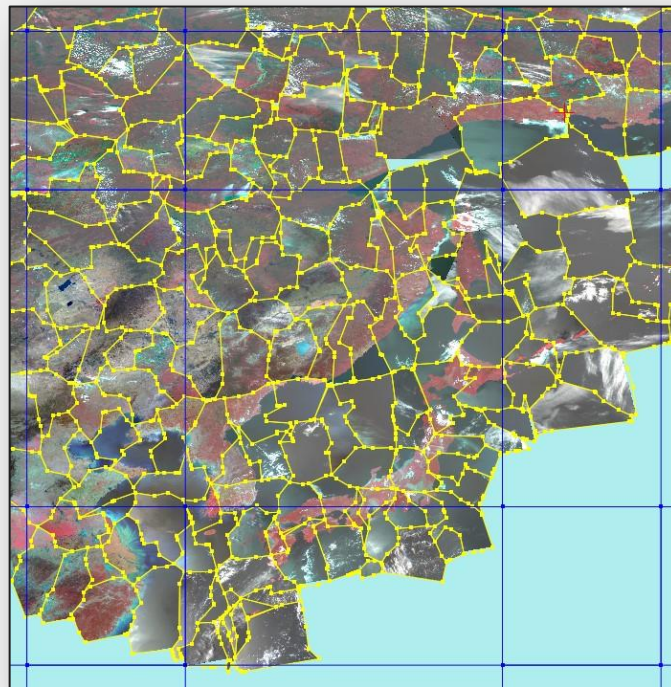
Результаты автоматического создания и интерактивного редактирования линий порезов на примере фрагмента БСП
